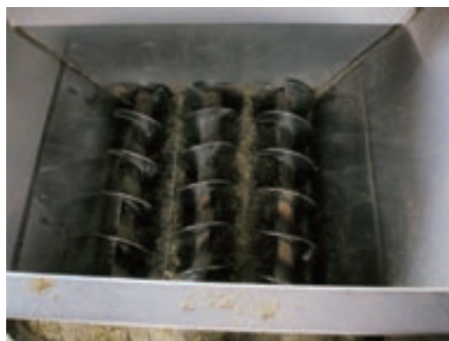
自动喂料车内部的螺旋装置
