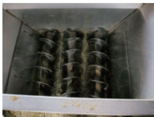
自动喂料车内部的螺旋装置
