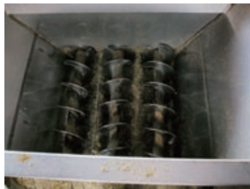
Baling-baling di bagian dalam mesin pemberi makan otomatis
