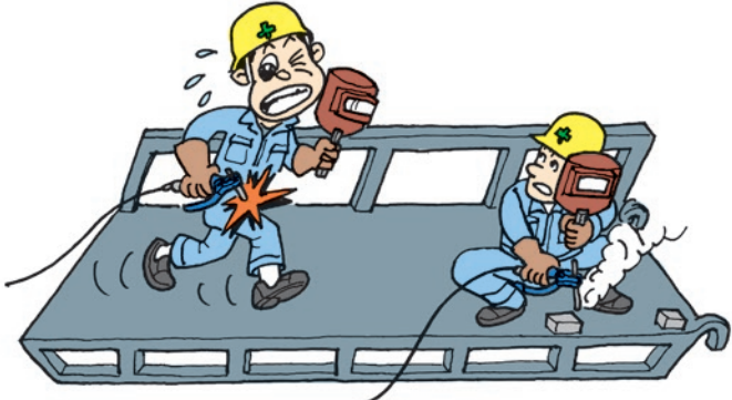
នៅពេលកំពុងធ្វើការងារផលិតក្តារជម្រាលធ្វើអំពីដែកថែប ដែកផ្សារ អាចប៉ះនឹងផ្នែកខាងនៃរាងកាយធ្វើអោយមានការឆក់អគ្គិសនី។
