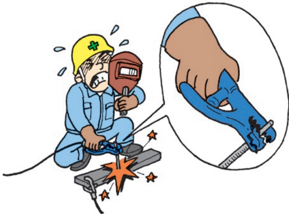
လျှပ်ခေါင်း၏လောင်၍ပျက်စီးမှုကြောင့် လျှပ်စစ်ရှောင် Cabtire ဝိုင်ယာကြိုး၏ပျက်စီးမှုကြောင့် လျှပ်စစ်ရှောင်
