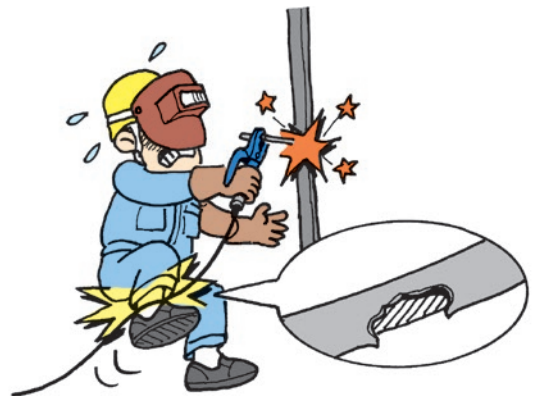
လျှပ်ကူးဂဟေဆော်စက်၏ကြိုးသွယ်ဝိုင်ယာကြိုးပေါ်နေခြင်းကြောင့်ဖြစ်သောလျှပ်စစ်ရှောင်
