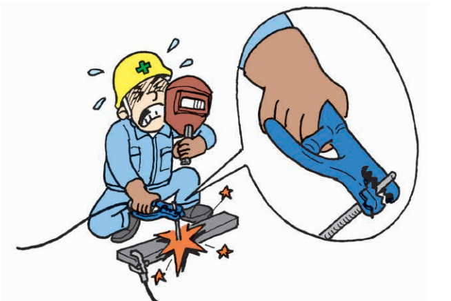
Electric shock na bunga ng paso sa electrode holder
