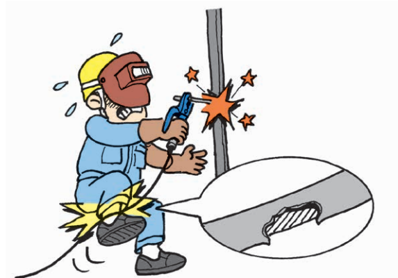
Electric shock na bunga ng paso sa electrode holder
