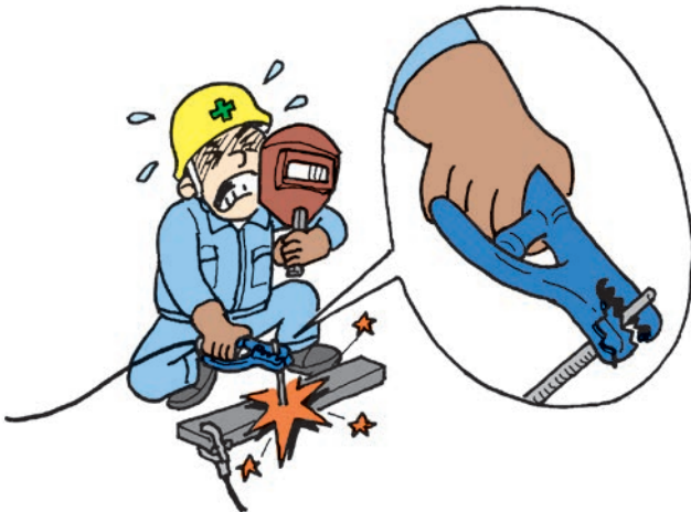
ไฟดูดจากการไหม้ของตัวตีปลวดเชื่อม ไฟดูดจากการชำรุดของสายไฟ (Cable) cable)
